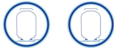
Un tunnel « monotube » est constitué de deux tunnels indépendants à une voie. Il implique la création de puits de secours tous les 800 mètres maximum.
