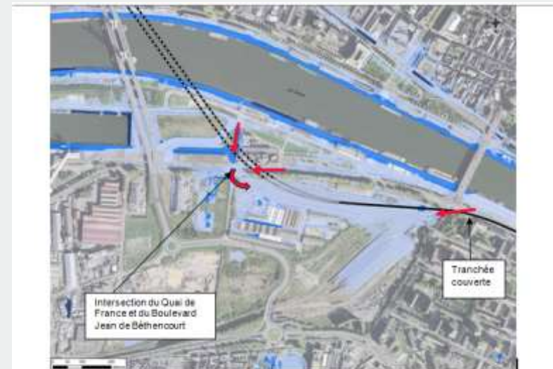
Figure 2 - Extrait zone inondable – évènement de premiers dommages (période de retour évaluée à 50 ans à l'état actuel et 25 ans avec prise en compte du réchauffement climatique)
